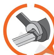
Dřík se šestihranným profilem tvaru šestihranné matice umožňuje nasazení vidlicového klíče při náročné práci, vyžadující extrémně vysoký kroutící moment.
